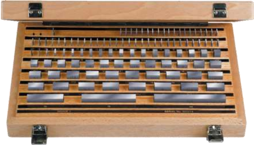
Набор плоскопараллельных концевых мер длины TESA. Метрические меры с номинальной длиной от 1 до 100 мм.
